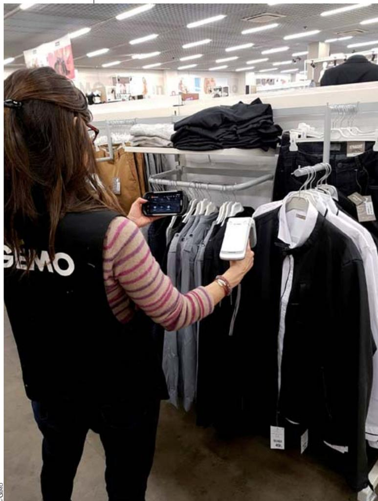
mini-tablette et d'un pistolet à antenne RFID, 5 personnes font l'inventaire complet des 10 à 15.000 articles du magasin en 1 h. Au lieu de ces 5 h de travail cumulées, il en fallait jusque-là 180 pour réaliser un inventaire physique une fois par an.
